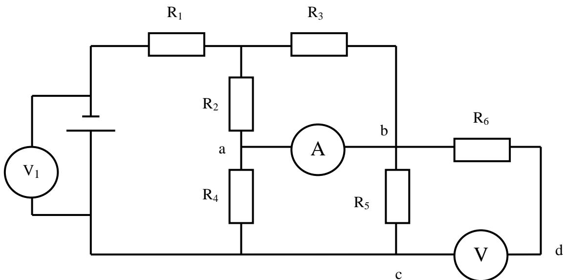
В электрической цепи, изображенной на рисунке, все измерительные приборы идеальны. Вольтметр, присоединённый к выводам батареи с внутренним сопротивлением 1 Ом, показывает 60 В. Сопротивления элементов цепи:  $R_1 = 1$  Ом,  $R_2 = R_3 = 4$  Ом,  $R_4 = 3$  Ом,  $R_5 = R_6 = 6$  Ом. Найти ЭДС батареи и показания амперметра А ( $I_{ab}$ ) и вольтметра В ( $U_{cd}$ ).
