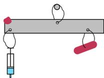
Подвесим рычаг с пустым шприцом массой  $m$  за центральную петлю и с помощью пластилина уравновесим его. К противоположной петле прикрепим исследуемый пластилин и наберем воду массой  $m_1$  в шприц, чтобы рычаг оказался в равновесии. Запишем правило моментов относительно точки подвеса рычага:  $V\rho gl_2 = m_1 l_1 g$ .
