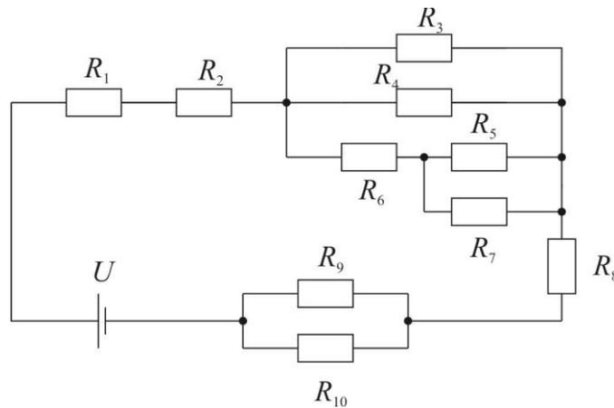
1. Каково должно быть максимальное напряжение на клеммах источника питания, при котором ни одни из резисторов не сгорит?
