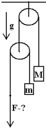
На рисунке представлена система из подвижного и неподвижного блоков и грузов  $m$  и  $M$ . С какой силой  $F$  тянут нить, если груз массы  $m$  опускается с тем же ускорением с каким поднимается груз массы  $M$ ? Трения нет, блоки невесомы, ускорение свободного падения  $g$ .
