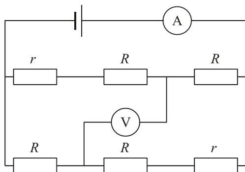
В схеме на рисунке амперметр  $A$  показывает ток  $I = 1$  А, а идеальный вольтметр  $V$  показывает напряжение  $U = 10$  В. Найдите сопротивление  $r$ .
