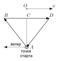
При полете по компасу на север (отрезок AB) смещение вдоль оси Ox: -Vt, поскольку направление движение коптера перпендикулярно ветру.
