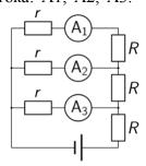
Запишем соотношение протекающих токов для участка с амперметрами  $A_1$  и  $A_2$ . Поскольку при параллельном соединении напряжения на цепочках совпадают, с использованием U = IR, мы можем написать отношение для токов и сопротивлений:
