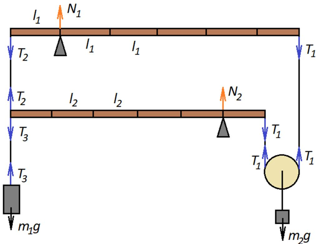
После расстановки сил запишем условие равновесия системы «блок-груз  $m_2$ »
