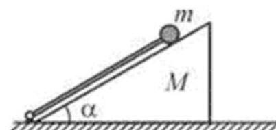
Систему освобождают и она начинает движение, во время которого шарик сохраняет контакт с клином. На какой максимальный угол  $\beta$  штанга отклонится от горизонтали после того, как клин отъедет от неё? Трением пренебречь. Удар шарика о горизонтальную плоскость считать абсолютно упругим.
