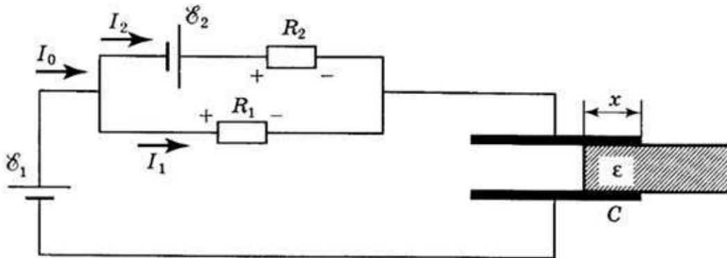
2. Запишем закон Ома для цепи, содержащей  $\mathcal{E}_1$ ,  $R_1$  и  $C$
