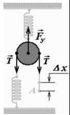
«Включим» теперь верхнюю пружину и запишем условия равновесия подвижного блока. Поскольку на блок действуют две силы натяжения нити  $\vec{T}$ , направленные вниз и сила упругости  $\vec{F}_y$  со стороны верхней пружины, направленная вверх (см. рис.), то, обозначив через  $\Delta x_2$  абсолютное удлинение верхней пружины, из условия равновесия блока, с учетом (2), получаем
