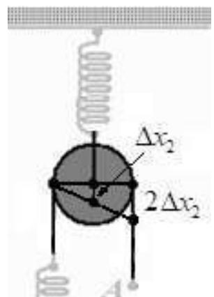
Если считать, что нижняя пружина не растягивается, то есть мысленно заменим её нерастяжимой нитью, то при опускании центра блока на  $\Delta x_2$  правый конец нити опустится на  $2\Delta x_2$  (см. рис.). Следовательно, результирующее смещение  $\Delta x$  вниз конца нити А с учётом деформаций обеих пружин (с учётом (1)) составит
