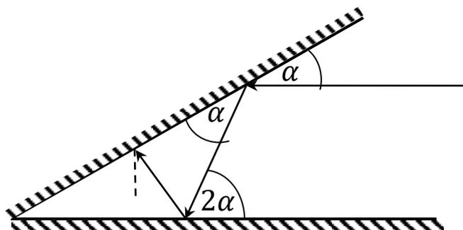
Так как угол падения равен углу отражения, то из рассмотрения 2, 3 и т.д. отражений можно получить, что угол между плоскостью зеркала и падающим лучом будет последовательно увеличиваться на  $\alpha = 15^\circ$  и при  $n$ -том отражении будет составлять  $\alpha_n = n\alpha$ . Луч развернется после  $n + 1$  отражений, если на  $n$ -том угол  $\alpha_n \geq 90^\circ$ . Таким образом в настоящей задаче  $n = 6$  и луч развернется в обратном направлении после семи отражений.
