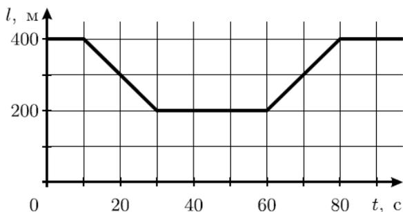
На длинном прямом шоссе автомобили движутся с постоянной скоростью  $V_1$  всюду, за исключением моста, на котором автомобили движутся с другой постоянной скоростью  $V_2$ . На рисунке изображён график зависимости расстояния  $l$  между двумя едущими друг за другом автомобилями от времени  $t$ . Найдите скорости  $V_1$  и  $V_2$ , а также длину моста.
