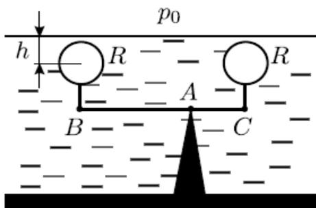
К рычагу, закреплённому на дне водоёма, прикреплены на нитях два сферических поплавка радиусом  $R$  (см. рисунок). В случае, если рычаг удерживать в горизонтальном положении, центры поплавков расположены на глубине  $h > R$ . На каких глубинах будут расположены центры поплавков, если отпустить рычаг и дождаться
