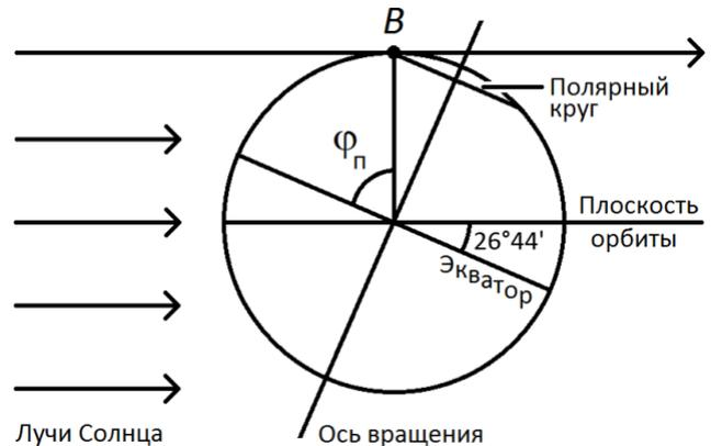
В момент солнцестояния на одном из полярных кругов Солнце должно находиться на горизонте. На рисунке это точка *B*. Из рисунка видно, что планетографическая широта полярного круга  $\varphi_p = 90^{\circ} - 26^{\circ}44' = 63^{\circ}16'$ .
