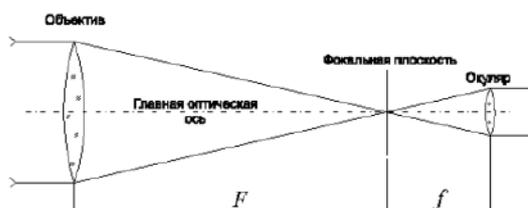
увеличения  $\Gamma = \frac{F}{f} = \frac{D}{d}$ , D - диаметр телескопа (входного пучка), F - фокус объектива, f - фокус окуляра, D - диаметр входного пучка, d -
