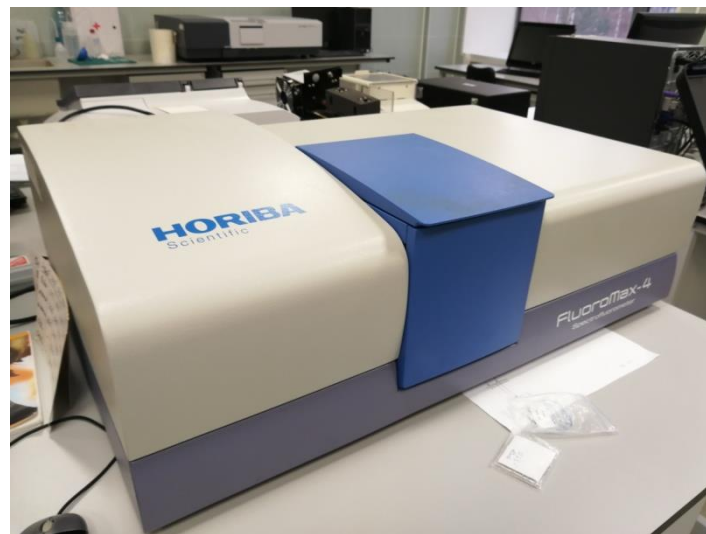
Прибор для измерения интенсивности испущенного света - спектрофлюориметр
