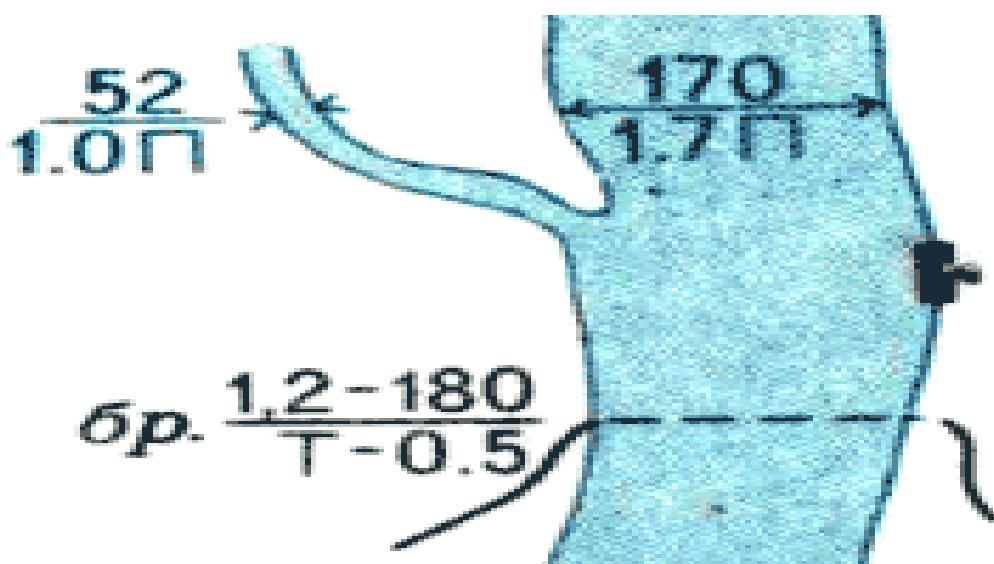
Характеристика рек и каналов: 170-ширина, 1,7-глубина в метрах, П-характер грунта дна
