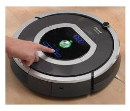
20. Современное устройство чаще всего представляет собой диск диаметром 28-35 см и высотой 9-13 см. В передней части робота обычно находится «бампер» - большой контактный сенсор, с помощью которого робот определяет столкновение с препятствиями. Внутри «бампера» обычно находятся бесконтактные датчики определения препятствий (состоящие из источника инфракрасного излучения и измерителя величины отраженного сигнала). О каком бытовом приборе идет речь? Каковы приимущества его использования?
