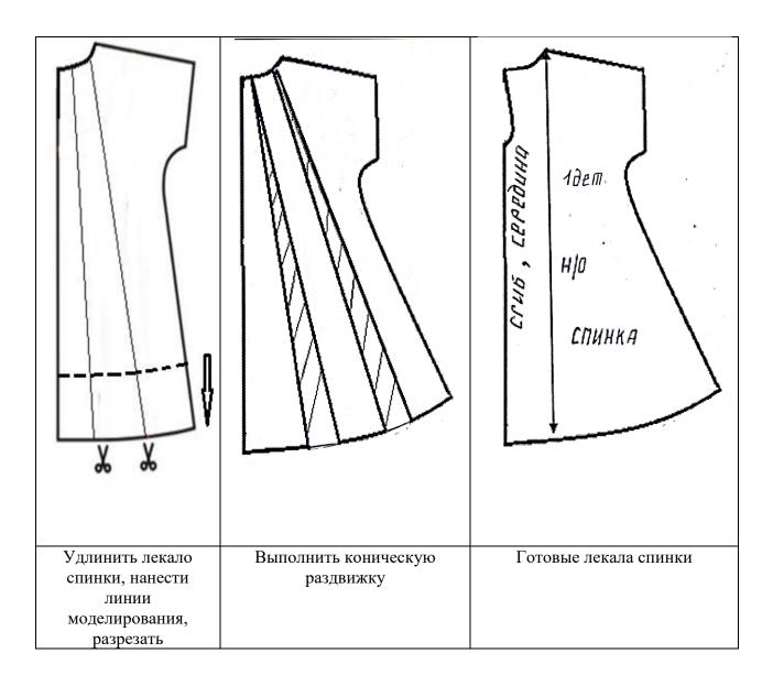
Рис.2.Контроль практического задания и результат моделирования (деталь спинки)
