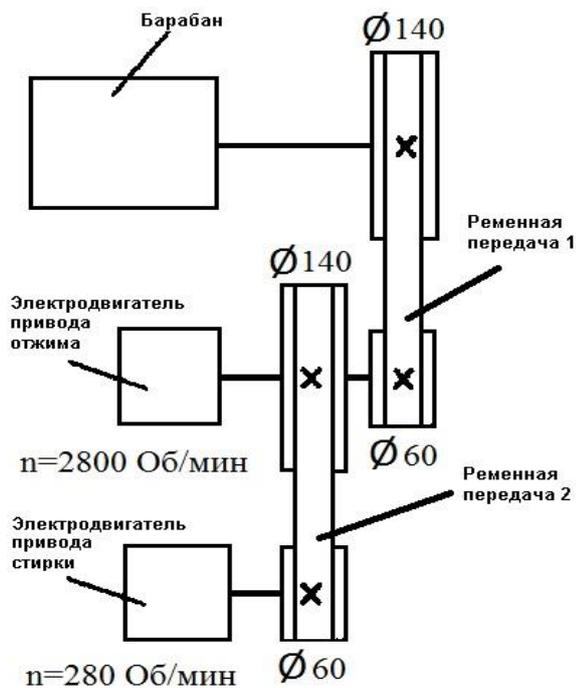
8. Для стиральной машины задания 7 определите скорость вращения барабана, если включен двигатель отжима, а двигатель стирки отключен.
