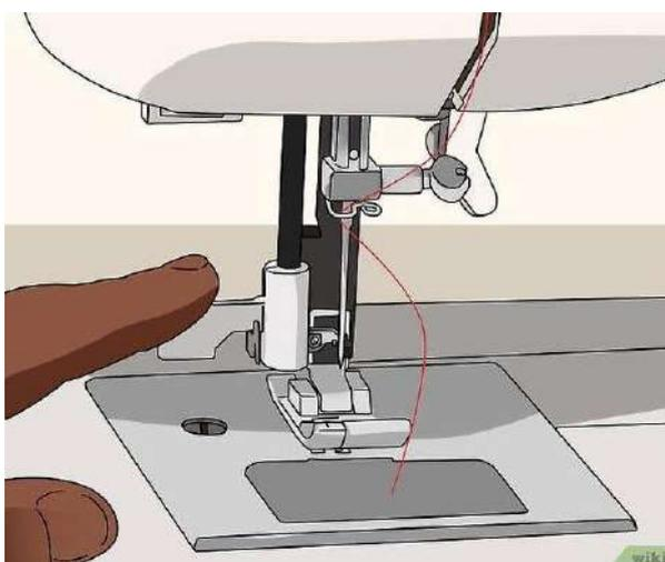
а) устройство полуавтоматической заправки верхней нити;
