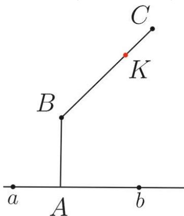
Штанга  $AB$  длиной  $l$  перпендикулярна полу и может ездить от точки  $a$  до точки  $b$  (расстояние между  $a$  и  $b$  равно  $2l$ ). Вторая часть конечности, штанга  $BC$  длиной  $2l$ , свободно поворачивается относительно шарнира  $B$ . По штанге  $BC$  ползает красящая насадка  $K$ .
