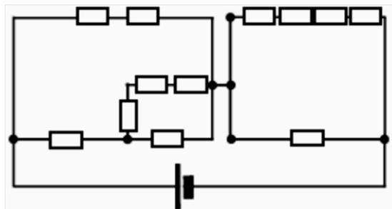
Здесь расчет схемы сводится к анализу последовательных и параллельных соединений. Сопротивление правой части схемы  $R_{np} = 4R/5$ , а для левой части схемы
