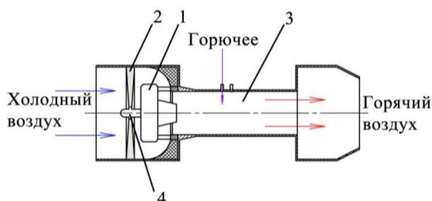
Вентилятор имеет диаметром  $120\text{ мм}$  и КПД  $60\%$ . Определите необходимую мощность электродвигателя, позволяющего обеспечить номинальную тягу после вентилятора в  $10\text{ Н}$ . В расчётах площадью сечения электродвигателя – 1 и втулки – 4 вентилятора пренебречь.
