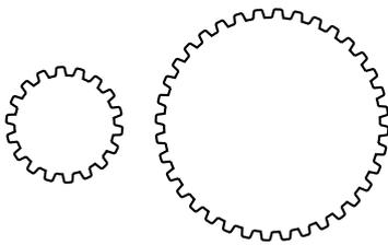
Так как количество зубцов достаточно велико, можно пренебречь изменением формы зубца и формы промежутка между зубцами. А в таком случае количество материала, удаляемое при вырезании одного зубца пропорционально толщине шестерёнки, то есть увеличилось втрое.
