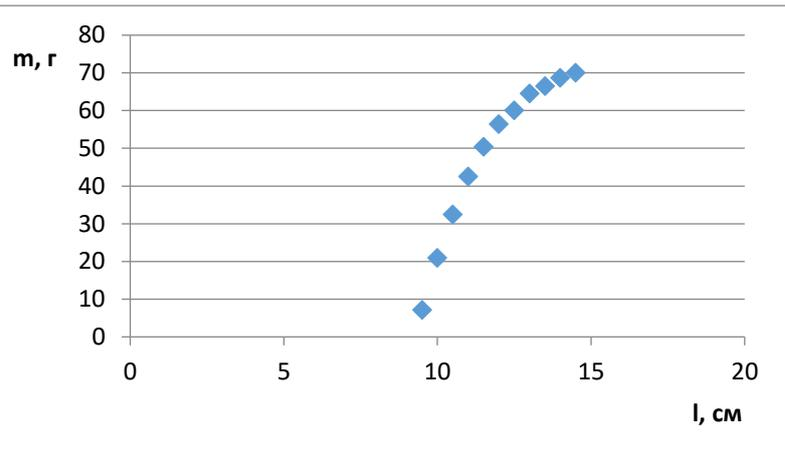
Сперва проверяем, что деформация подчиняется закону Гука. По линейке измеряем удлинение, по показаниям весов силу упругости. Строим график зависимости показаний весов от длины пружины  $m(l)$  и замечаем, что зависимость не везде линейная.
