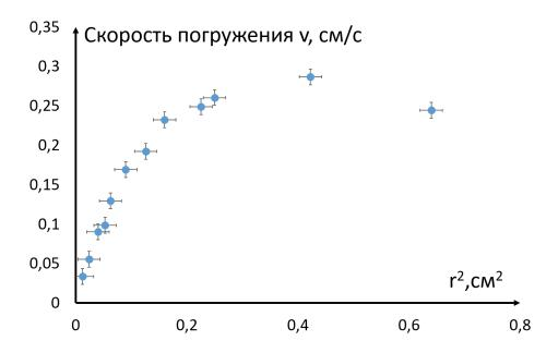
5. Однако, если мы хотим определить вязкость, нам нужно найти линейную область. Она находится при малых радиусах шарика относительно радиуса трубки. Находим угловой коэффициент  $k=1.75\pm0.05~1/(c~*\text{ cm})$ . Зная плотности жидкости и шара находим вязкость (не забывая о размерности коэффициента).  $\eta = \frac{2}{9k}g(\rho_1 - \rho_2) = 4.6~\Pi \text{a/c}$ .
