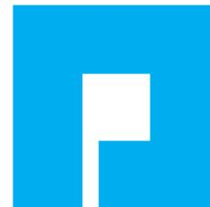
Пропорции рисунка: квадрат имеет размеры 3 на 3, квадратный вырез размеров 1 на 1, расположен ровно посередине, к нему ведёт прорезь шириной 0.25.
