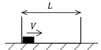
**Ответ.** Путь, пройденный коробкой, равен  $V^2/(4\mu g)$ . Путь, пройденный шайбой, равен  $(1 + n)L$ , где  $n$  равно целой части отношения  $V^2/(4\mu gL)$ .
