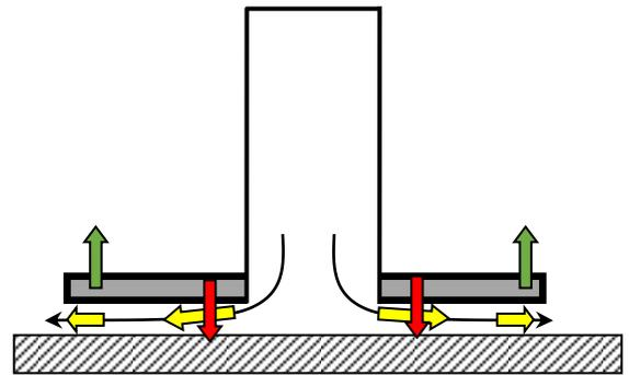
от поверхности, также возникают силы, препятствующие этому. Если зазор между диском и отверстием мал, то силы вязкого трения увеличиваются, поток тормозится, давление жидкости на диск растет, и он отталкивается от поверхности. **4 б.**
