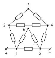
Обозначим через R каждое из исходных сопротивлений. В получившейся схеме верхний треугольник 234 состоит из двух сопротивлений 2R, соединённых параллельно. Общее сопротивления этого треугольника равно:
