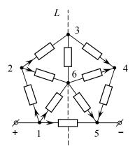
Пусть положительный полюс батареи подключён к точке 1, а отрицательный к точке 5. Рассматриваемая схема зеркально симметрична относительно прямой L, проходящей через точки 3 и 6. Поэтому распределение токов также зеркально симметрично. Это означает, что выполняются следующие равенства:
