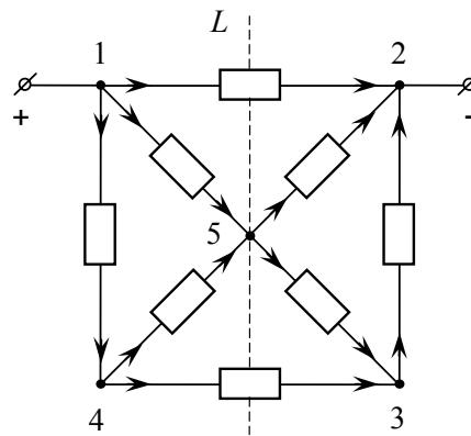
Пусть положительный полюс батареи подключён к точке 1, а отрицательный к точке 2. Рассматриваемая схема зеркально симметрична относительно прямой  $L$ , проходящей через точку 5. Поэтому распределение токов также зеркально симметрично. Это означает, что выполняются следующие равенства:
