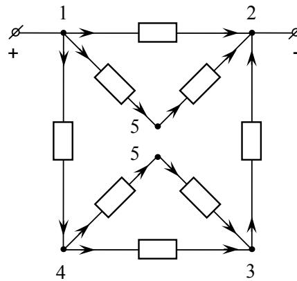
Обозначим через  $R$  каждое из исходных сопротивлений. В получившейся схеме треугольник 453 состоит из сопротивлений  $R$  и  $2R$ , соединённых параллельно. Общее сопротивление этого треугольника равно:
