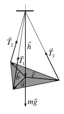
$\vec{T}_1 = -k_1(\vec{h} + \vec{a})\,, \quad \vec{T}_2 = -k_2(\vec{h} + \vec{b})\,, \quad \vec{T}_3 = -k_3(\vec{h} + \vec{c})\,, \quad$ где  $k_1\,, \quad k_2\,$  и  $k_3\,$  - некоторые числа, имеющие размерности Н/м. Подставляя силы натяжения в условие равновесия треугольника, получим
