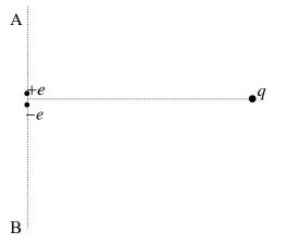
**5.** Точечный положительный заряд q удерживают на расстоянии l от двух точечных зарядов +e и -e (e>0), закрепленных на очень малом расстоянии d друг от друга. Направление на заряд q из середины отрезка, соединяющего заряды +e и -e, перпендикулярно этому отрезку (см. рисунок). В некоторый момент времени заряд q отпускают. На каком расстоянии от середины отрезка, соединяющего заряды +e и -e заряд q пересечет прямую, на которой лежат
