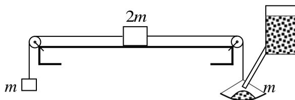
рез блок, укрепленный на противоположном краю стола, а к ней привязали чашку массой  $m$  (см. рисунок). Затем в эту чашку насыпали тонкой струйкой песок из бункера. Найти ускорение тел, если масса песка в чашке вдвое превосходит ту минимальную массу песка, при которой тела сдвинутся с места. Коэффициент трения между телом  $2m$  и поверхностью  $\mu$ .
