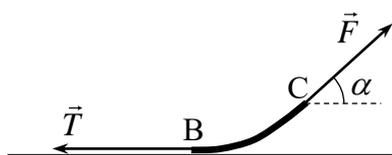
где  $(1/4)m$  - его масса,  $\vec{T}$  - сила натяжения веревки в точке В, действующая на участок ВС со стороны участка АВ и направленная горизонтально (см. рисунок). В проекциях на горизонтальную и вертикальную оси это условие дает
