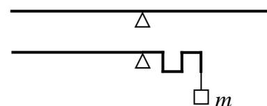
нужно прикрепить к концу стержня (нижний рисунок), чтобы равновесие стержня не нарушилось?
