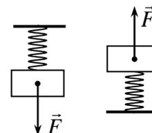
Найти отношение силы тяжести груза к силе  $F$ . При любых удлинениях пружины справедлив закон Гука: удлинение пружины пропорционально приложенной к ней силе.
