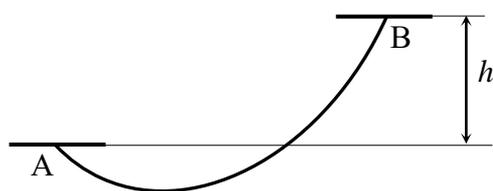
3. Однородную нерастяжимую гибкую веревку массой  $m$  и длиной  $l$  подвесили в двух точках А и В, находящихся на разных высотах (см. рисунок). Сила натяжения веревки в точке А известна и равна  $T_A$ . Найти силу натяжения веревки в точке В, которая находится на  $h$  выше точки А.
