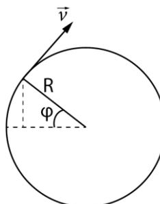
Капли вылетают по касательной со скоростью  $\omega(t)R = \omega_0 R - 2\mu gt$ , под некоторым углом  $\varphi$ . Начальная высота капли:
