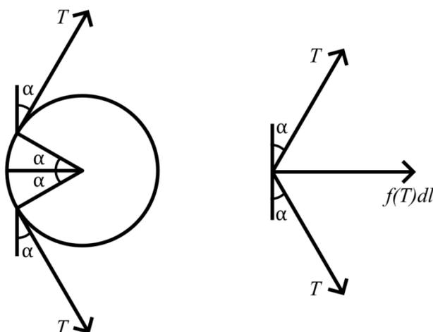
Рисунок 2. Иллюстрация возникновения силы, прижимающей нить к цилиндру
