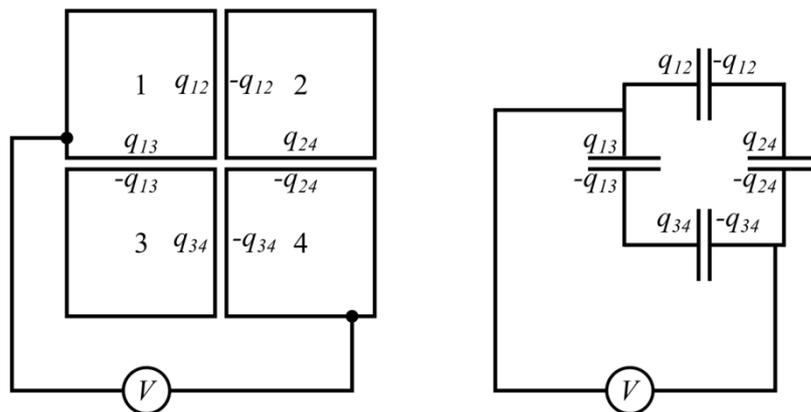
Рис.4 Система после изменения с подписанными зарядами граней кубов (слева) и схема замещения (справа).
