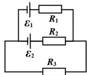
**Решение (10 баллов).** Запишем уравнения Кирхгофа. Выберем направления токов, и условимся обходить контуры по часовой стрелке. Согласно первому уравнению Кирхгофа:
