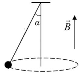
**Решение (10 баллов).** На шарик действуют сила тяжести  $m\vec{g}$ , сила натяжения нити  $\vec{F}_H$  и сила Лоренца  $\vec{F}_L$ . В сумме они сообщают телу центростремительное ускорение  $a = v^2/r$ , направленное к центру окружности. Центростремительная сила определяется как:
