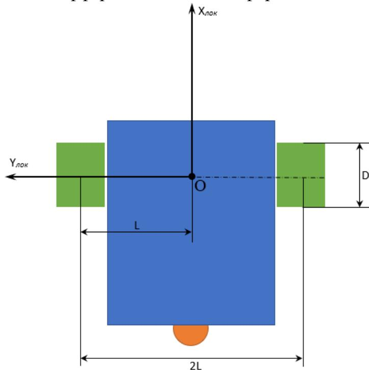
$D$  – диаметр колес робота
