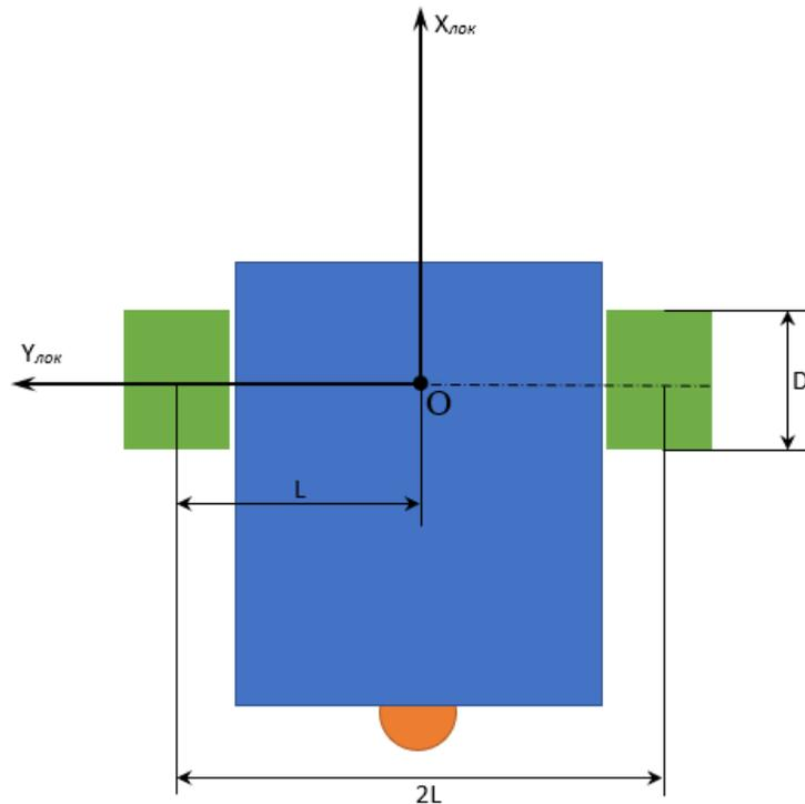
$D$  – диаметр колес робота
