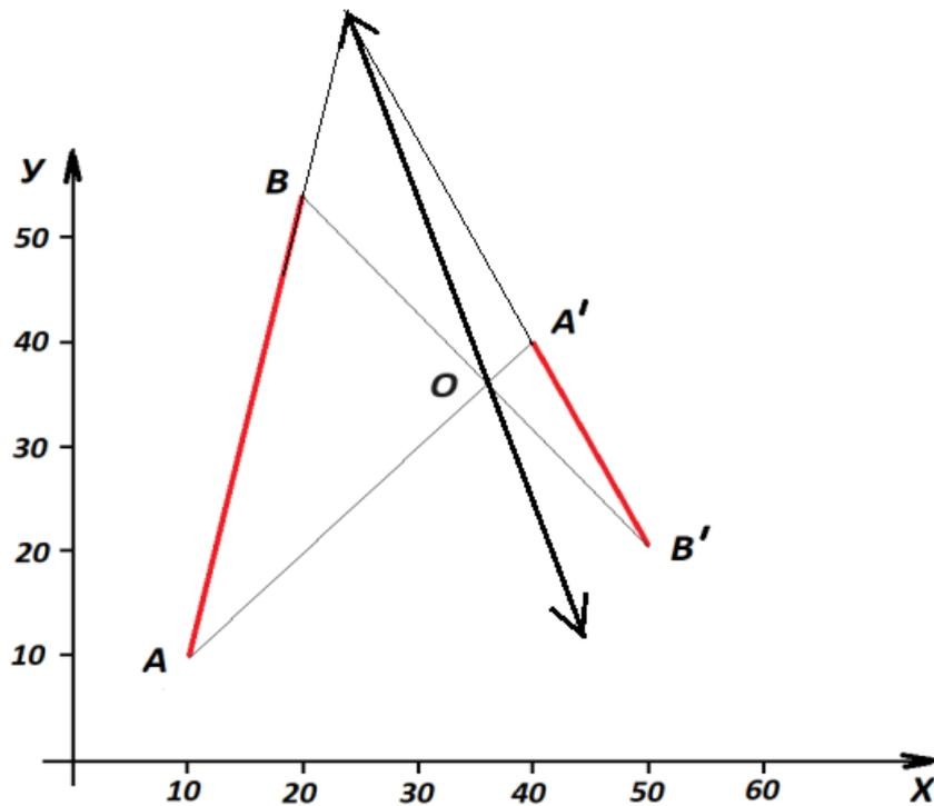
Через оптический центр проводим прямые параллельные  $AB$  и  $A'B'$ . Их пересечения с лучами  $A'B'$  и  $AB$  дают положения фокальных плоскостей (на рисунке зеленым цветом).
