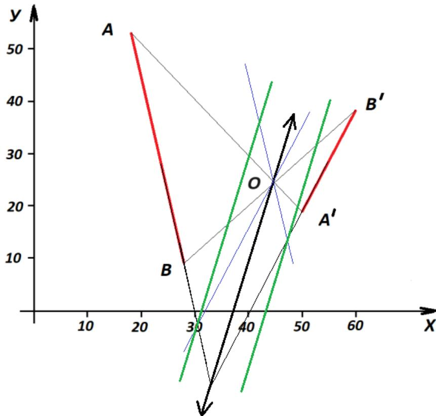
Из оптического центра опускаем перпендикуляры на фокальные плоскости. Получаем местоположение главных фокусов (38; 26) и (50; 23).
