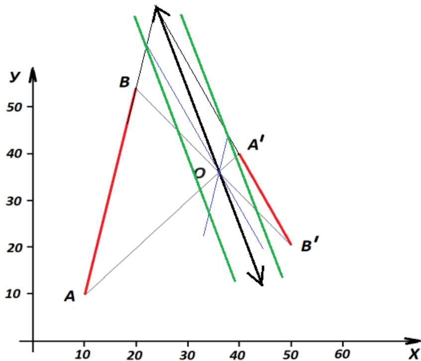
Из оптического центра опускаем перпендикуляры на фокальные плоскости. Получаем местоположение главных фокусов (32; 34) и (40; 38).
