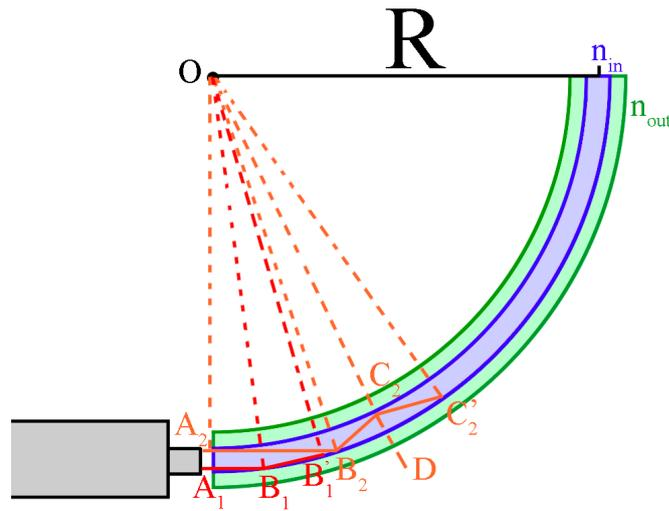
1. В первую очередь, запишем закон преломления для луча, падающего под углом  $\alpha$  на границу сердцевины и оболочки оптоволокна
