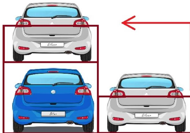
Если в кратце, то устройство работает так: автомобиль въезжает на специальную платформу, после чего та передвигается сначала вверх, затем вправо или влево (предусмотрены оба варианта движения для одной и той же платформы). При этом движение может осуществляться вокруг стоящего ниже другого автомобиля. Спуск автомобиля производится в обратном порядке.
