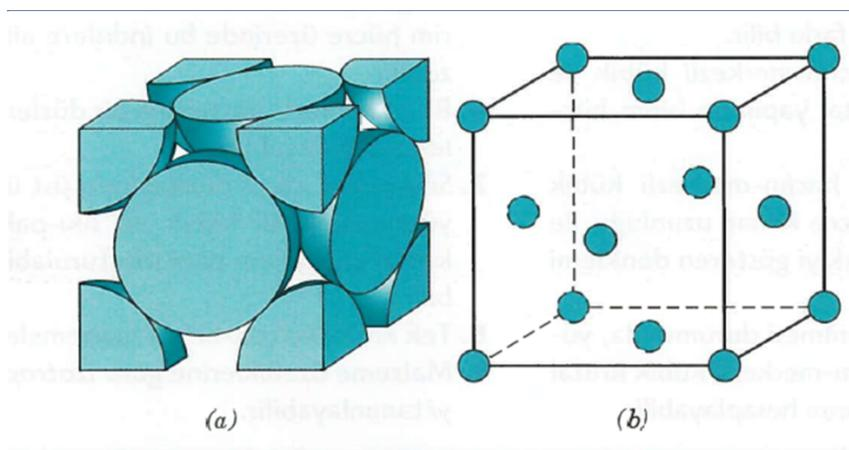
Рис. VI.1.1. Элементарная ячейка кристаллической гранецентрированной кубической решетки **Z**
