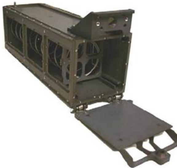
Рис. VI.2.2. P-POD для вывода МКА на орбиту
