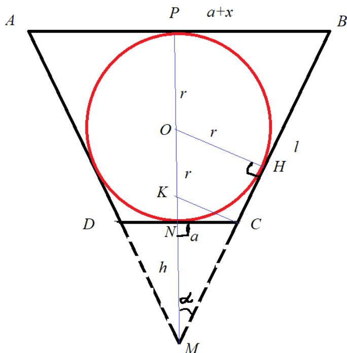
Отрезок  $AB$  — уровень воды, равнобедренный треугольник  $AMB$  — сечение полного конуса, равнобедренная описанная трапеция  $ABCD$  — сечение исходного усечённого конуса. Имеем:
