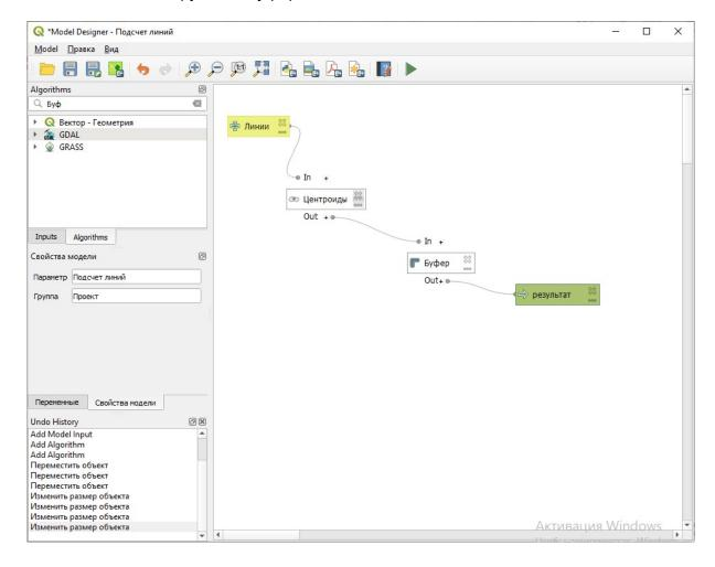
11. После создания модели найдём её в панели инструментов и применим для слоя со «взорванными линиями».
