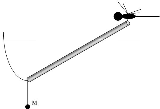
Найти массу стрекозы, если известно, что объём поплавка составляет  $2 \text{ см}^3$ , его масса –  $0.84 \text{ г}$ , а масса груза  $M = 0.54 \text{ г}$ . Масса поплавка равномерно распределена вдоль его длины. Считать известным то, что сила тяжести приложена в середине поплавка, а сила Архимеда – в середине его подводной части. Натяжением лески выше крепления к поплавку, как и поверхностным натяжением воды, можно пренебречь. Плотность воды принять равной  $1 \text{ г/см}^3$ .
