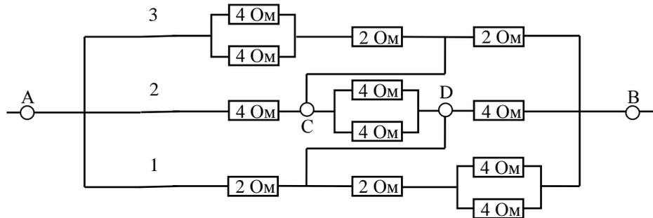
Если посмотреть на схему, то можно выделить точки C и D. Для того чтобы понять, как протекает ток в этих точках, посчитаем сопротивления на интервалах AC и AD.
