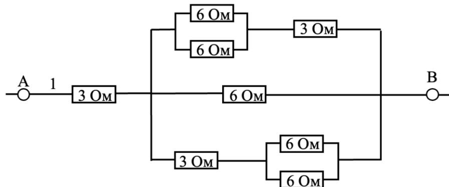
Рассчитаем эквивалентное сопротивление такой цепи. Для участков с параллельным соединением по 6 Ом:
