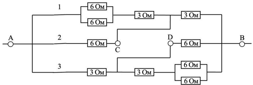
Получаем два одинаковых параллельных участка. Посчитаем общее сопротивление верхнего, которое состоит из участка AC (3 Ом), последовательно соединенного с резистором 3 Ом. Получаем общее сопротивление верхней цепи равное 6 Ом.
