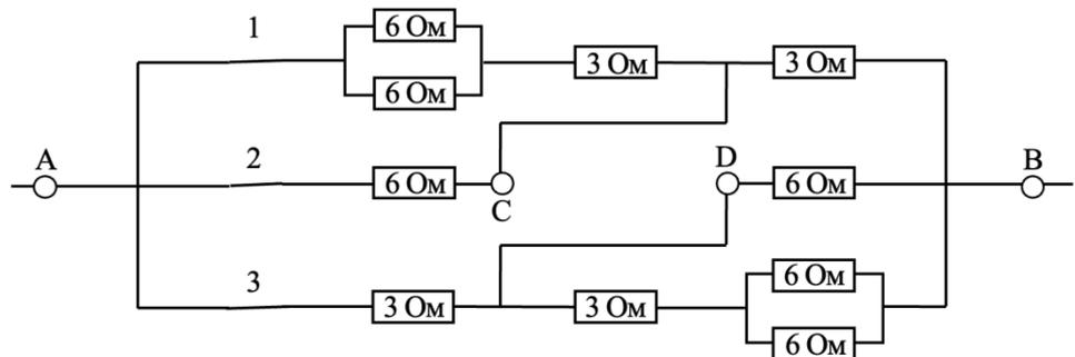
Получаем два одинаковых параллельных участка. Посчитаем общее сопротивление верхнего, которое состоит из участка AC (3 Ом), последовательно соединенного с резистором 3 Ом. Получаем общее
