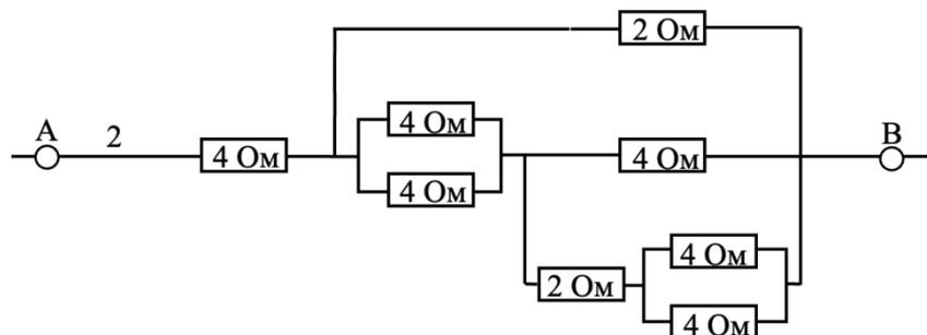
Сопротивление нижнего участка, состоящего из последовательного и двух параллельных соединений, мы уже считали:
