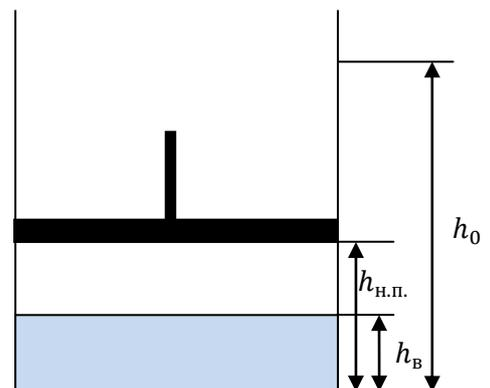
При медленном изотермическом перемещении поршня будет справедлив закон Бойля-Мариотта ( $pV = \text{const}$ ). Давление будет подниматься до достижения давления насыщенного пара для этой температуры, которое как мы знаем, при температуре кипения воды в  $100^\circ\text{C}$  равно атмосферному  $p_{\text{н.п.}} = 10^5 \text{ Па}$ . Далее (схема 2) при дальнейшем движении поршня давление повышаться уже не будет, а пар будет конденсироваться.
