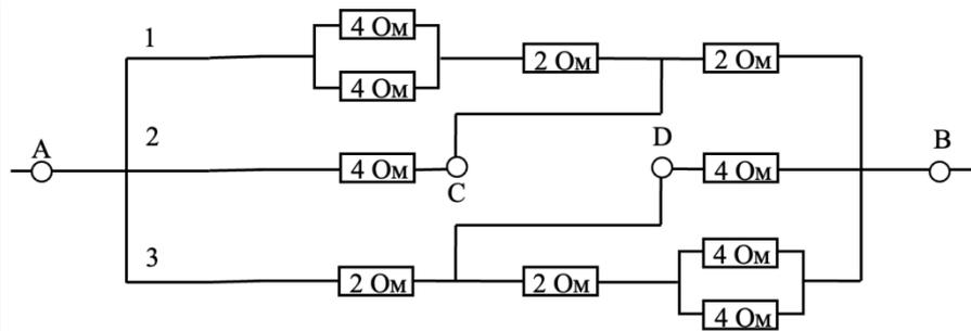
Получаем два одинаковых параллельных участка. Посчитаем общее сопротивление верхнего, которое состоит из участка AC (2 Ом), последовательно соединенного с резистором 2 Ом. Получаем общее сопротивление верхней цепи равное 4 Ом.
