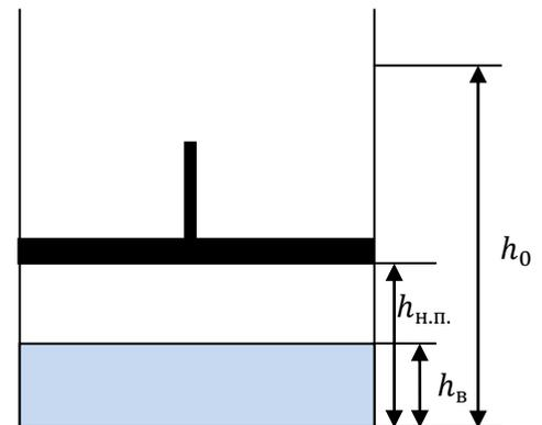
При медленном изотермическом перемещении поршня будет справедлив закон Бойля-Мариотта ( $pv = \text{const}$ ). Давление будет подниматься до достижения давления насыщенного пара для этой температуры, которое как мы знаем, при температуре кипения воды в  $100^\circ\text{C}$  равно атмосферному  $p_{\text{н.п.}} = 10^5 \text{ Па}$ . Далее (схема 2)
