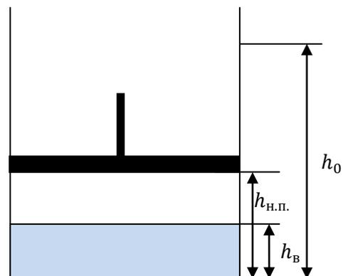
*При медленном изотермическом перемещении поршня будет справедлив закон Бойля-Мариотта ( $pV = \text{const}$ ). Давление будет подниматься до достижения давления насыщенного пара для этой температуры, которое как мы знаем, при температуре кипения воды в 100°C равно атмосферному  $p_{\text{н.п.}} = 10^5$  Па. Далее (схема 2) при дальнейшем движении поршня давление повышаться уже не будет, а пар будет конденсироваться.*
