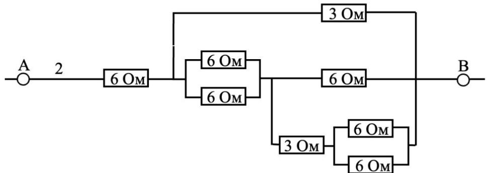
Сопротивление нижнего участка, состоящего из последовательного и двух параллельных соединений, мы уже считали:
