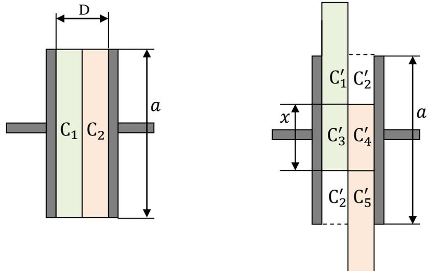
1) Определим емкость конденсатора в первом случае. Так как пластины в конденсаторе расположены друг за другом, такую систему можно представить, как два последовательно соединенных конденсатора.
