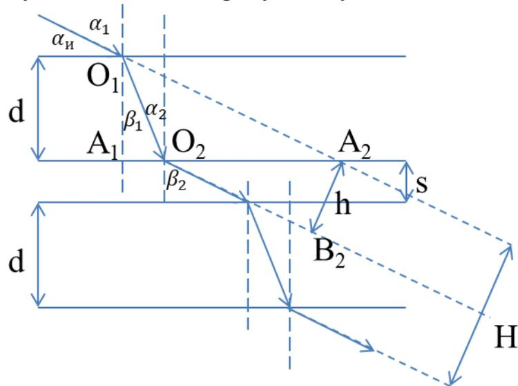
На этом рисунке  $d$  – ширина пластины кронгласа;  $s$  – расстояние между пластинами;  $h$  – смещение солнечного лучика после прохождения одной пластины;  $H$  – смещение солнечного лучика после прохождения двух пластин;  $\alpha_1$  – угол падения;  $\beta_1$  – угол преломления;  $\alpha_2$  – вертикальный к предыдущему угол;  $\beta_2$  – угол вылета из кронгласа;  $\alpha_n$  – угол к поверхности. Угол к поверхности является дополнительным к углу падения:
