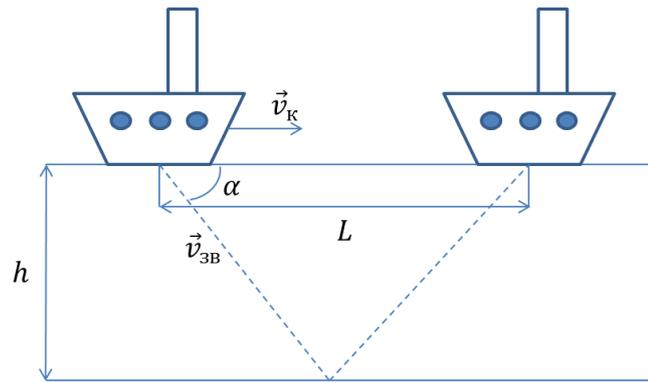
На этом рисунке  $\vec{v}_{зв}$  – скорость звука,  $\vec{v}_к$  – скорость корабля,  $\alpha$  – угол между поверхностью моря и направлением распространения звука,  $h$  – глубина моря,  $L$  – расстояние, которое успел проплыть корабль.
