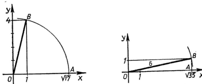
Можно решить иначе. Действительно  $(\sqrt{n})^2 = 1 \cdot n$ . Значит  $\sqrt{n}$  – среднее пропорциональное между 1 и  $n$ , поэтому можно использовать свойство перпендикуляра, проведенного из точки окружности на ее диаметр.
