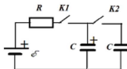
ключ  $K_1$  размыкают, затем замыкают ключ  $K_2$ . После установления равновесия в системе конденсаторов ключ  $K_2$  размыкают, а затем повторно замыкают ключ  $K_1$ . Определите количество теплоты, выделившееся в резисторе за промежуток времени от момента первого замыкания ключа  $K_1$  до окончания переходных процессов после повторного замыкания ключа  $K_1$ .
