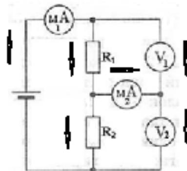
$$\text{Ответ: } R_2 = \frac{U_2 + \frac{I_2}{I_1}(\varepsilon - U_1 - U_2)}{I_1 - I_2 \left(1 + \frac{U_1}{U_1 + U_2}\right)} \approx 1,6 \text{ кОм.}$$
