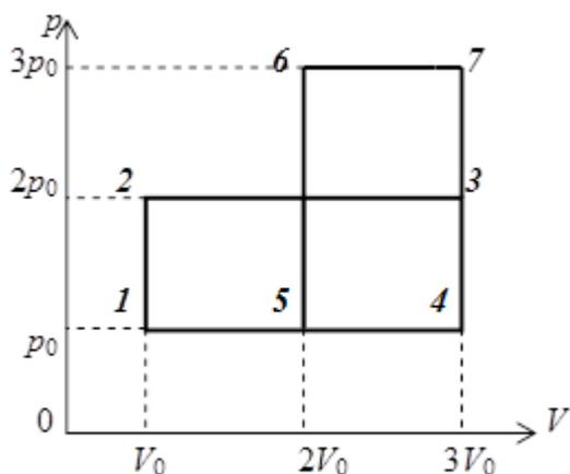
**5. (4 балла)** Определите отношение  $\eta_1/\eta_2$  коэффициентов полезного действия двух циклических процессов, проведённых с идеальным одноатомным газом: 1-2-3-4-1 (первый процесс) и 5-6-7-4-5 (второй процесс). Графики процессов представлены на рисунке.
