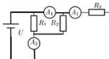
Здесь ток через резистор  $R_2$  обозначен как  $I_2$ . Ток через амперметр  $A_1$  равен сумме токов  $I_2$  и  $I_3$ :
