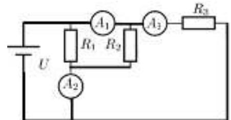
Здесь токи через резисторы  $R_1$ ,  $R_2$  и  $R_3$  обозначены как  $I_1$ ,  $I_2$  и  $I_3$  соответственно. Ток через амперметр  $A_2$  равен сумме токов  $I_1$  и  $I_2$ :
