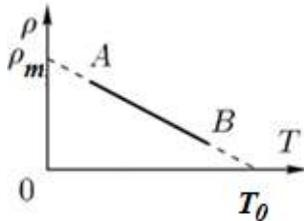
**5. (4 балла)** В идеальном газе осуществляют процесс  $AB$ , изображённом на рисунке в координатах  $(\rho, T)$ , где  $\rho$  – плотность газа, а  $T$  – его температура. Определите плотность газа, при которой давление газа в данном процессе максимально. Плотность  $\rho_m$  известна. Считайте, что  $\rho_B < \rho_m / 3$ , а  $\rho_A > 3\rho_m / 4$ .
