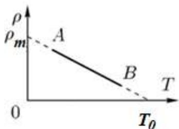
**5. (4 балла)** В идеальном газе осуществляют процесс  $AB$ , изображённом на рисунке в координатах  $(\rho, T)$ , где  $\rho$  – плотность газа, а  $T$  – его температура. Определите температуру, при которой давление газа в данном процессе максимально. Температура  $T_0$  известна. Считайте, что  $T_A < T_0 / 3$ , а  $T_B > 3T_0 / 4$ .
