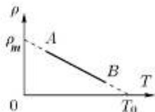
1. (6 баллов) Одноатомный идеальный газ участвует в процессе  $AB$ , изображённом на рисунке в координатах  $(\rho, T)$ , где  $\rho$  – плотность газа, а  $T$  – его температура. Давление газа в точке  $A$  составляет  $1/4$  от максимального в этом процессе. Определите температуру в точке  $A$ . Температура  $T_0$  известна.
