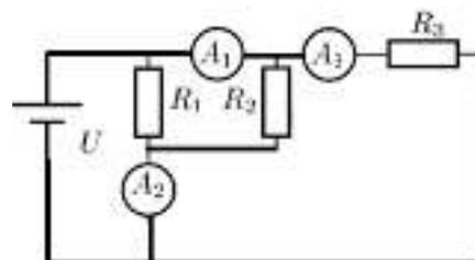
Здесь токи через резисторы  $R_1$  и  $R_2$  обозначены как  $I_1$  и  $I_2$  соответственно. Ток через амперметр  $A_2$  равен сумме токов  $I_1$  и  $I_2$ :
