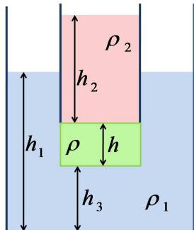
Полую трубу с очень тонкими стенками удерживают в вертикальном положении. Нижний конец трубы погружён в сосуд с жидкостью 1 плотностью  $\rho_1=1.18 \text{ г/см}^3$ . Снизу к торцу трубы плотно прилегает цилиндрическая пластина плотностью  $\rho=0.52 \text{ г/см}^3$ . Она опирается о стенки трубы, но никак не закреплена и держится только за счёт давления жидкости 1. Площадь
