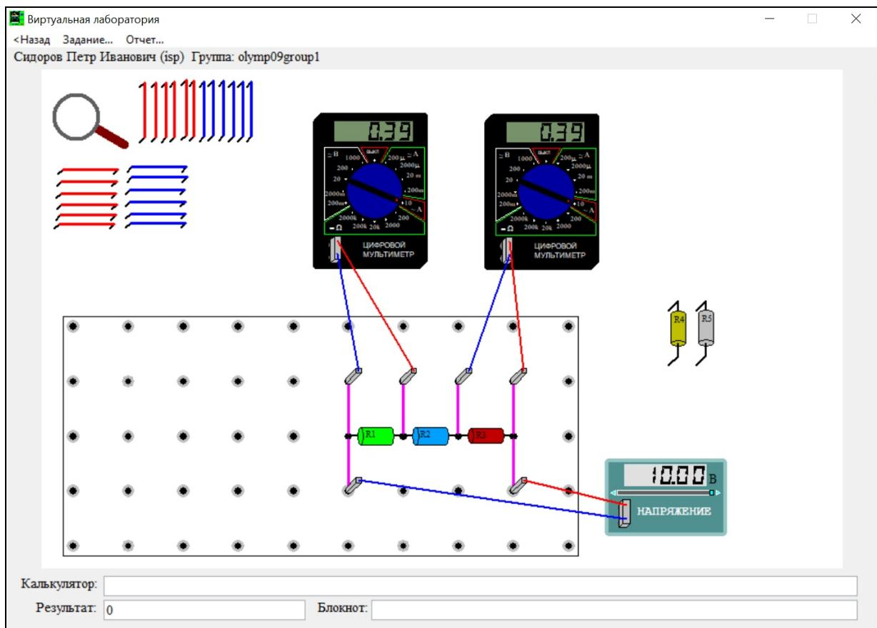
В этом режиме мультиметры показывают для подходящего диапазона тока 10 А две значащие цифры тока. Это мало для необходимой точности измерений, поэтому мы уменьшим напряжение источника так, чтобы можно было переключиться на диапазон тока 200 мА. Подходящим оказывается, например, напряжение  $V_2=5.00$  В, при нем протекающий через резистор  $R_2$  ток оказывается равен  $J_2=196.1$  мА – см. следующий рисунок.
